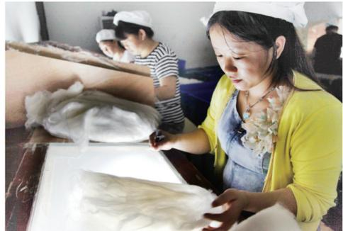
江苏吴江德顺纺织有限公司是一家通过精炼、制绵、纺纱等工艺将蚕茧、制丝、织成中的疵茧、废丝加工成纱线的民营企业，该企业年进口绢纺废丝320吨，经过加工精炼后，可产生出长吐、汰头、绵球、由丝、混纺纱、落绵、真丝等产品，产品远销英国、澳大利亚和意大利等国，年产值1000万元人民币。图为工人在剔除绵片中的杂质。(陈 曦 摄)
